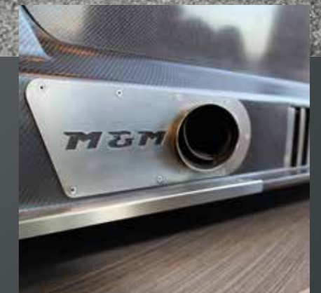
Sidepipes mit Schwellerentlüftung. Edelstahl Abgasanlage mit Schalldämpfern und Katalysatoren
